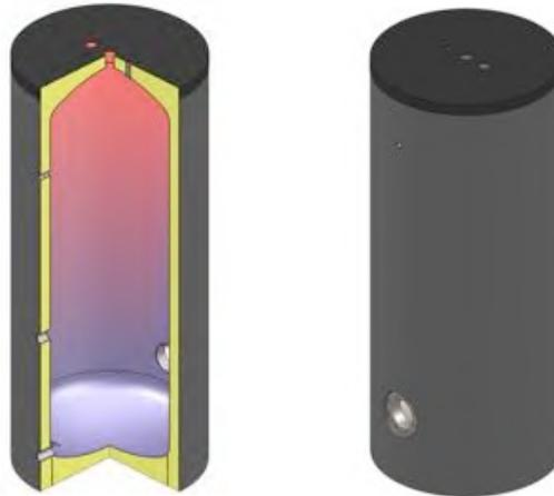
Die emaillierten Speicher können, ergänzt mit einer Elektroheizung (Zubehör), als Elektrospeicher verwendet werden. Ab 600 Liter auch mit zwei Elektroheizungen für die lastabhängige Zuschaltung. Mit einem externen Plattenwärmetauscher können die Speicher auch als Schichtenspeicher verwendet werden. Muffen für eine optimale Schichtung sind vorhanden. Bei höheren Lademengen kann über eine Ladelanze (Zubehör) die Einschichtung von Trinkwasser noch zusätzlich optimiert werden.
